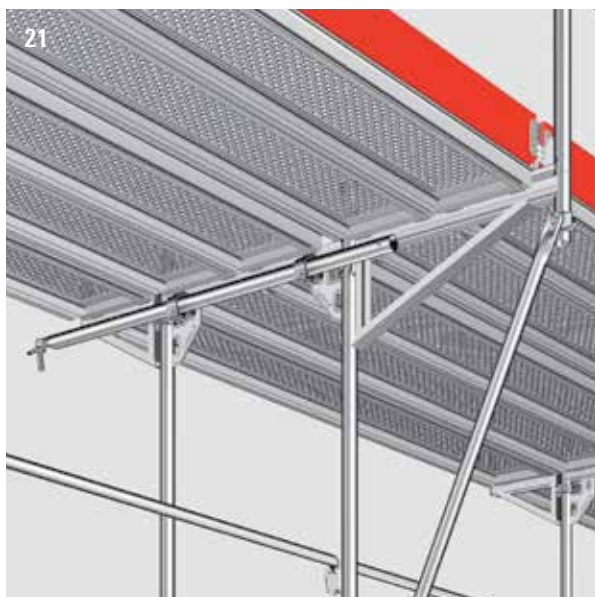
21 Förankringsrör med dubbla förankringskopplingar för SpeedyScaf.
